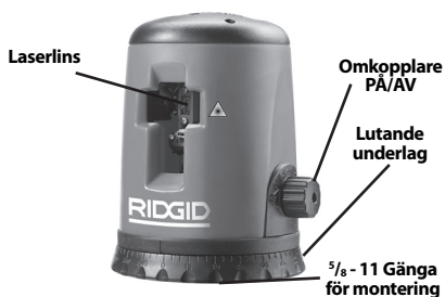
Figur 2 - Laserns delar
