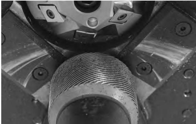
Figure 22 – Nettoyage du moletage du galet d'entraînement
