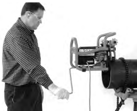
Figure 19 – Position de travail appropriée
