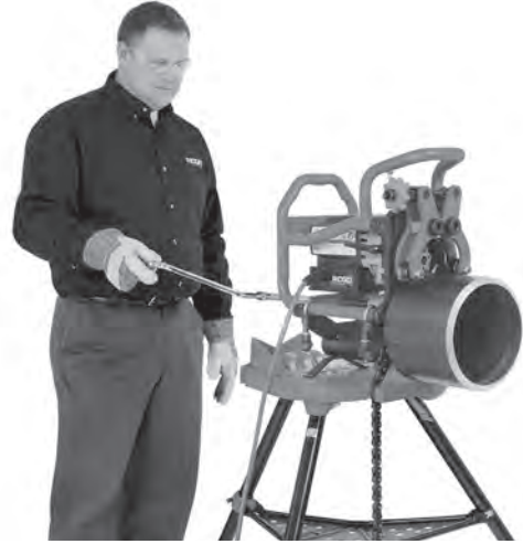
Şekil 20C – Pahlama İşlemi (Sabit Pahlama Makinesi/ Dönen Boru)
