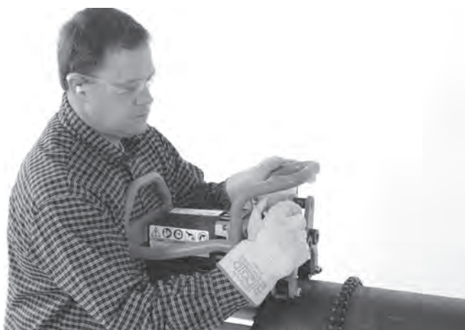
Рис. 17А – Затягивание зажимного винта от руки
