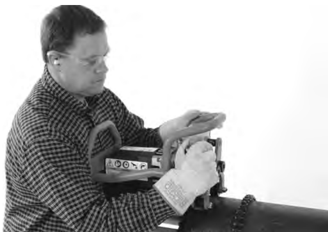
Figure 17A – Serrer la vis de blocage manuellement
