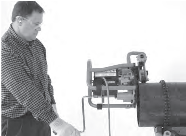
Рис. 20А – Операция по снятию фаски (закрепленная заготовка/перемещение станка)
