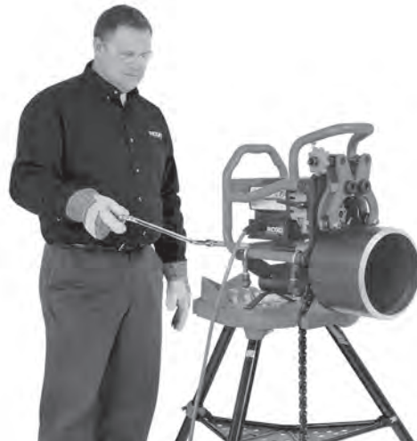
Рис. 20С – Операция по снятию фаски (закрепленный станок для снятия фаски/вращение трубы)
