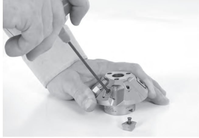
Şekil 24 – Kesici Bagaların Değiştirilmesi
