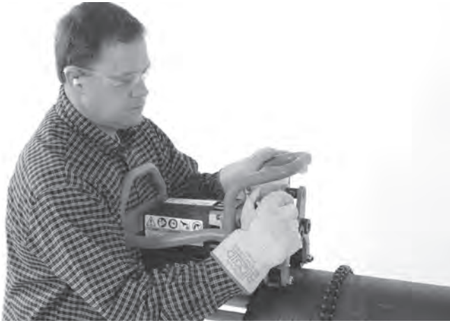
Şekil 17A – Sıkıştırma Vidasını Elle Sıkın
