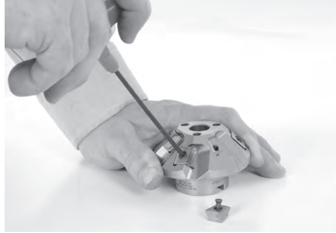
Şekil 24 – Kesici Bagaların Değiştirilmesi
