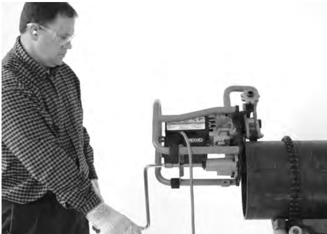
Figura 20A – Operación de biselado (pieza fija/biseladora móvil)
