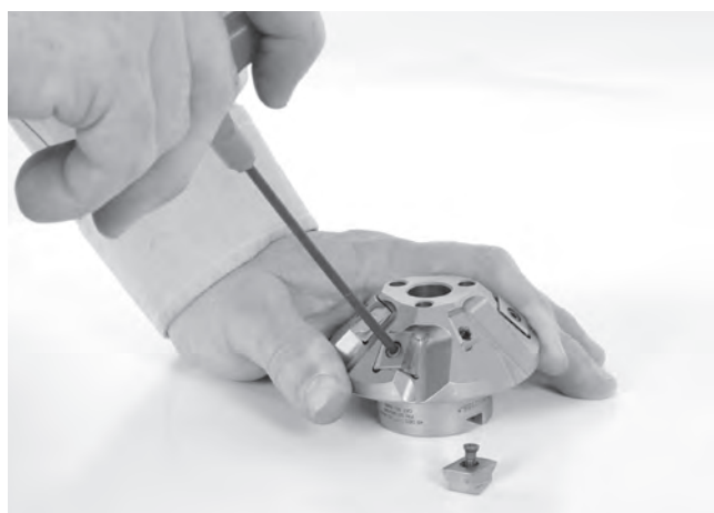
Рис. 24 – Замена вставных резцов
