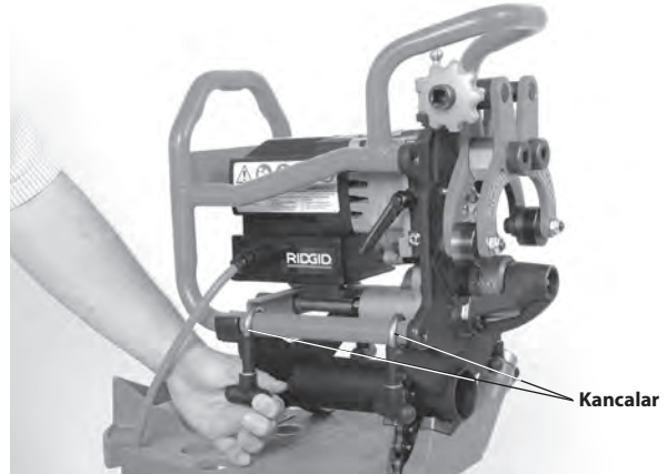
Şekil 9 – Pahlama Makinesinin Adaptöre Tespit Edilmesi
