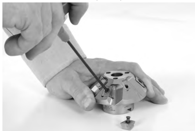
Figura 24 – Cambio de las placas de corte en el cabezal
