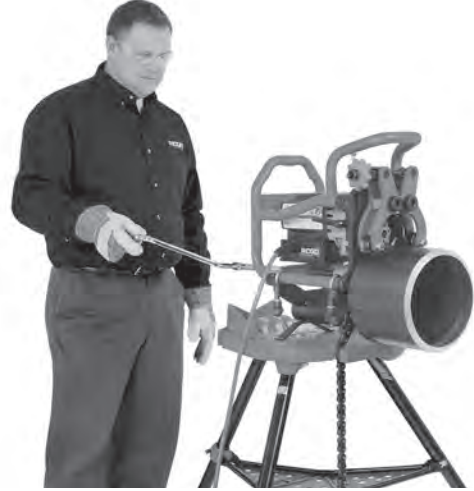
Şekil 20C – Pahlama İşlemi (Sabit Pahlama Makinesi/ Dönen Boru)
