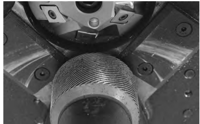
Figura 22 – Superficie moleteada del rodillo de mando, limpia
