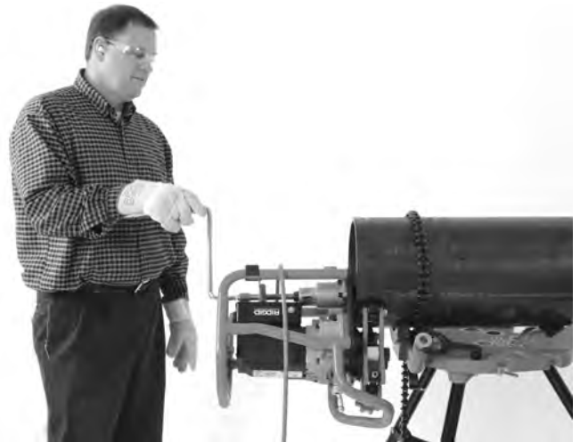
Figura 20B – Operación de biselado (pieza fija/biseladora móvil)
