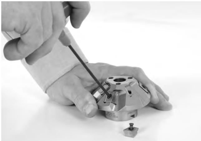
Figure 24 – Remplacement des couteaux
