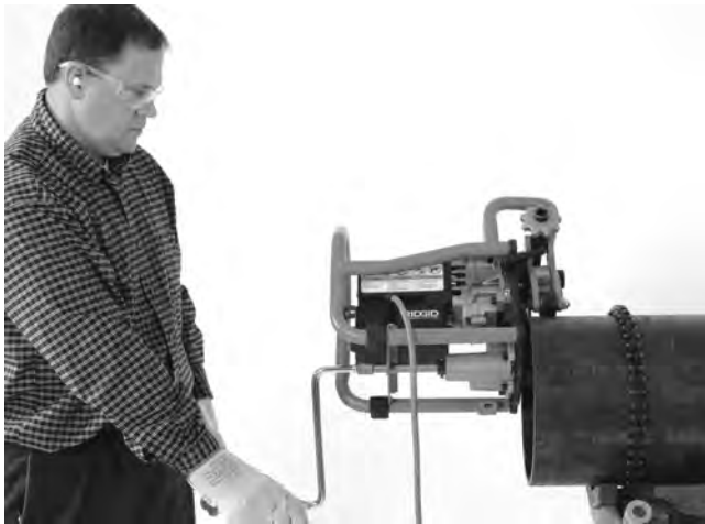
Figure 20A – Biseautage en cours (pièce fixe/machine mobile)
