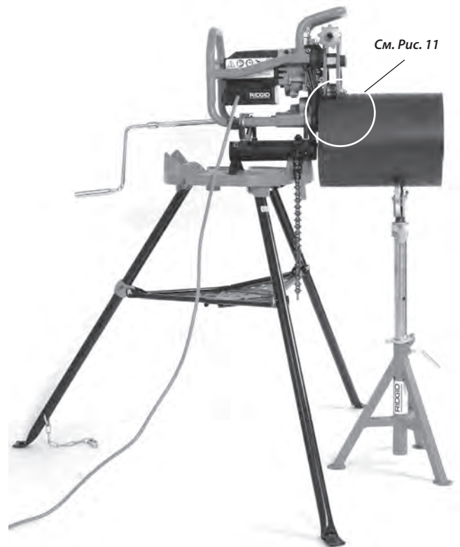
Рис. 12 – Закрепленный станок для снятия фаски, короткая труба, одна опора для трубы
