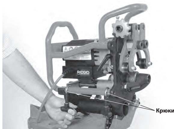
Рис. 9 – Крепление станка для снятия фаски к держателю
