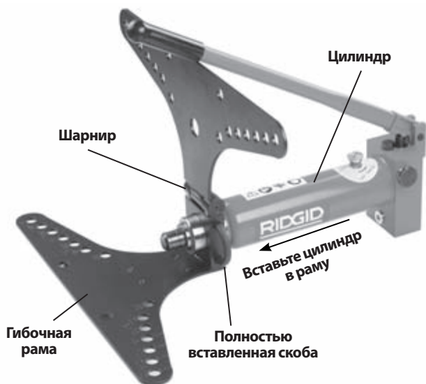
Рис.5 – Сборка 2" и 3" гибочных машин
