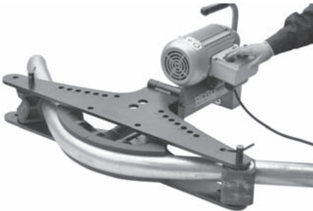
Kuva 14: Sähkökäyttöisen taivuttimen käyttö
