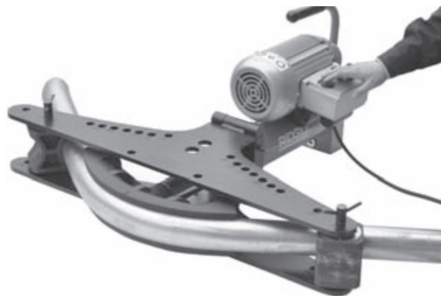
14. ábra – A villamos hajlító gép üzemeltetése
