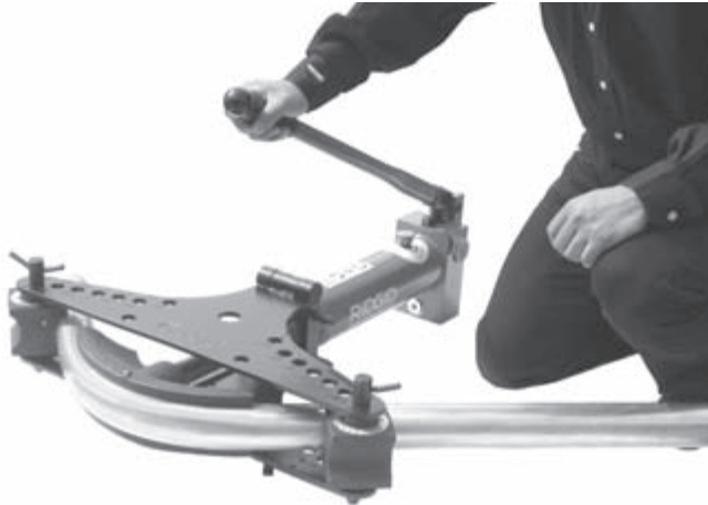
Kuva 13: Manuaalisen taivuttimen käyttö
