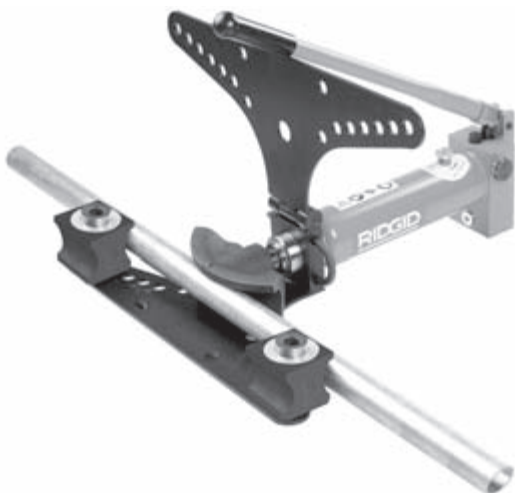
Figur 9 – Sette i røret
