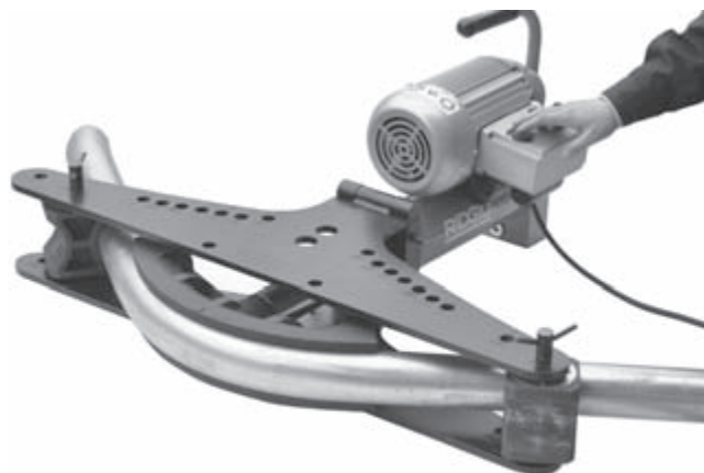
Figura 14 – Trabalhar com o Curvador Eléctrico
