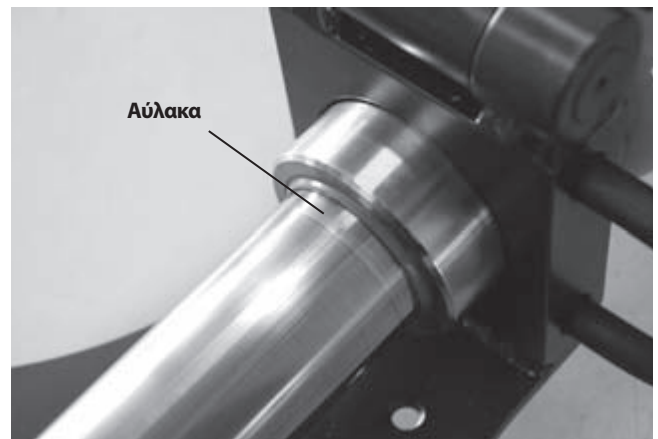
Εικόνα 16 – Αύλακα στο έμβολο
