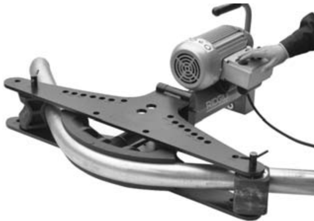
Figura 14 – La doblatubos eléctrica en acción
