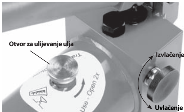
Slika 10 – Položaji otpusnog gumba (izvlačenje/uvlačenje)
