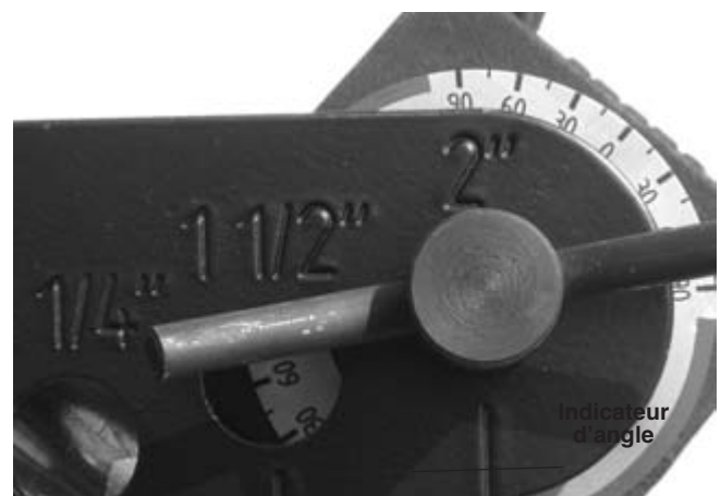
Figure 15 – Indicateur d'angle en fin de cintrage
