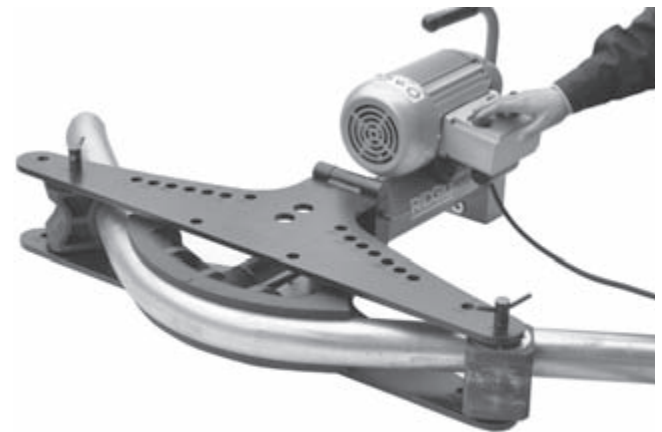
Şekil 14 - Elektrikli Bükücüleri Çalıştırma
