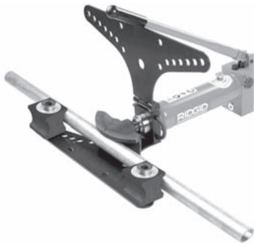
Abbildung 9 – Einlegen des Rohrs
