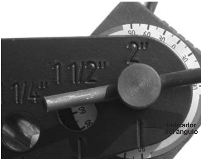
Figura 15 – Indicador del ángulo, término del doblamiento
