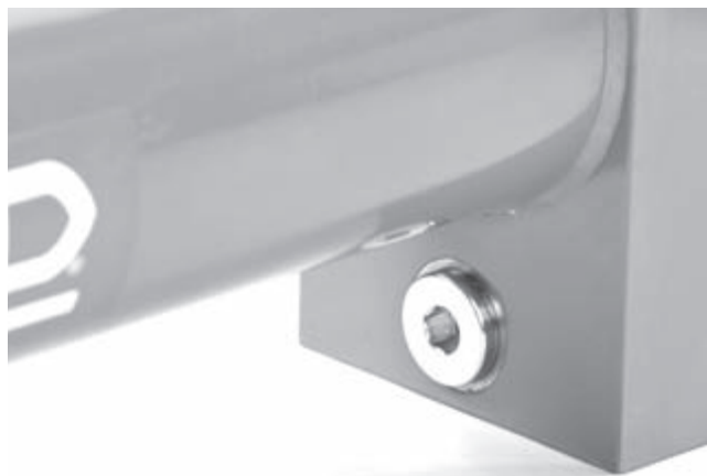
Abbildung 19 – Hydrauliköl-Ablasstopfen und Zugang zum Filter
