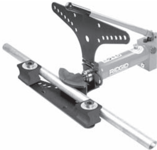
Figuur 9 – De pijp aanbrengen in de machine
