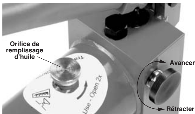
Figure 10 – Positions de la molette de verrouillage (Avancer/Rétracter)
