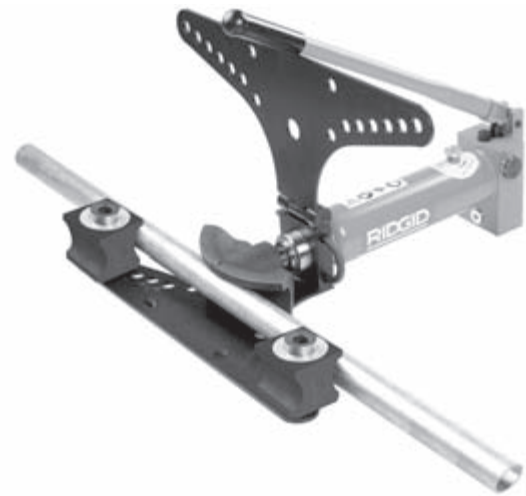
Εικόνα 9 – Φόρτωση του σωλήνα
