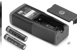
Figure 5 – Remplacement des piles
