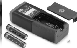
Figura 5 – Instalación de las pilas
