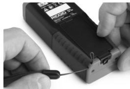
Figura 4 – Instalação da Correia
