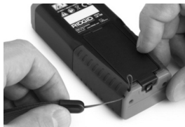
Obrázek 4 – Instalace šňůry na zavěšení
